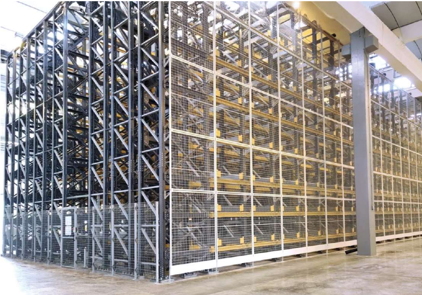
Przykład zastosowań systemu Screen w zautomatyzowanym magazynie wykonanym przez firmę Automha SpA.
