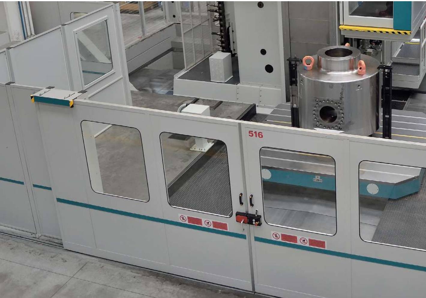
Przykład zastosowania wodoszczelnej obudowy zabezpieczającej przed wydostawaniem się opiłków.
