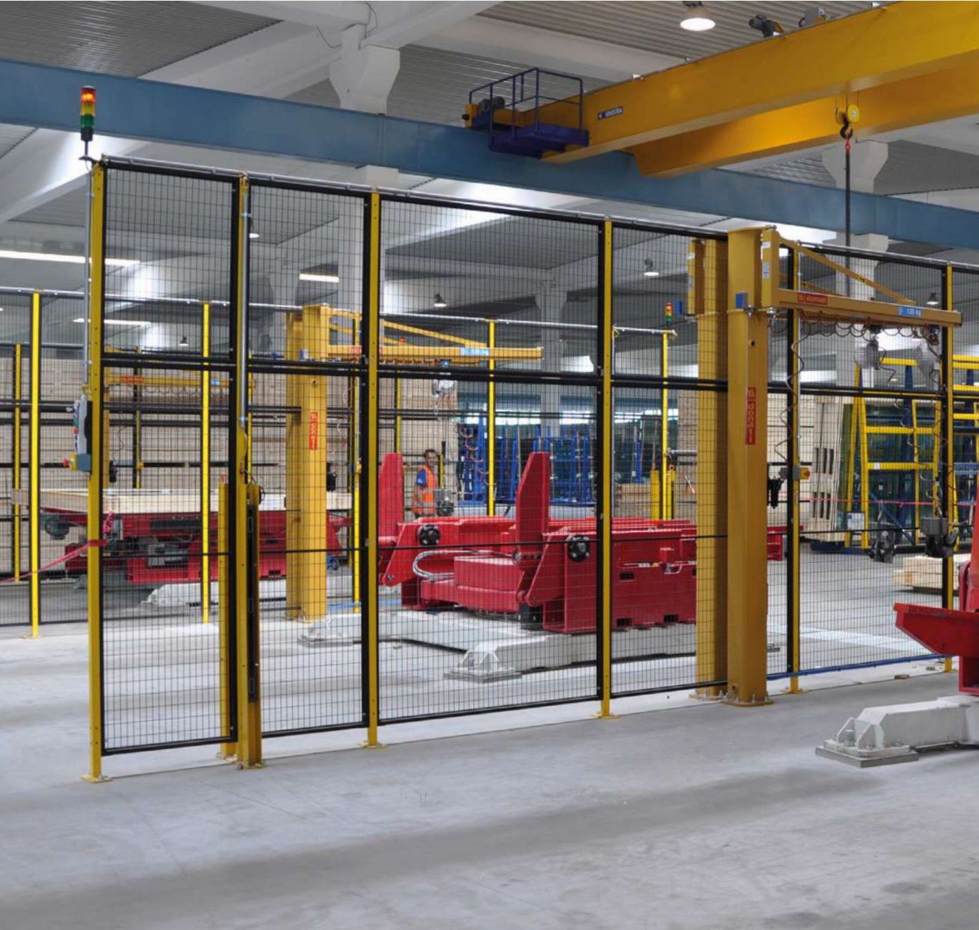
Przykład zastosowania systemu Novatek do wygrodzenia stref, w których odbywa się przenoszenie ładunków na dużej wysokości.
