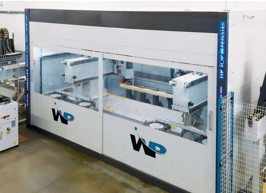
Przykład zastosowania obudowy z podwójnymi drzwiami z przodu.
