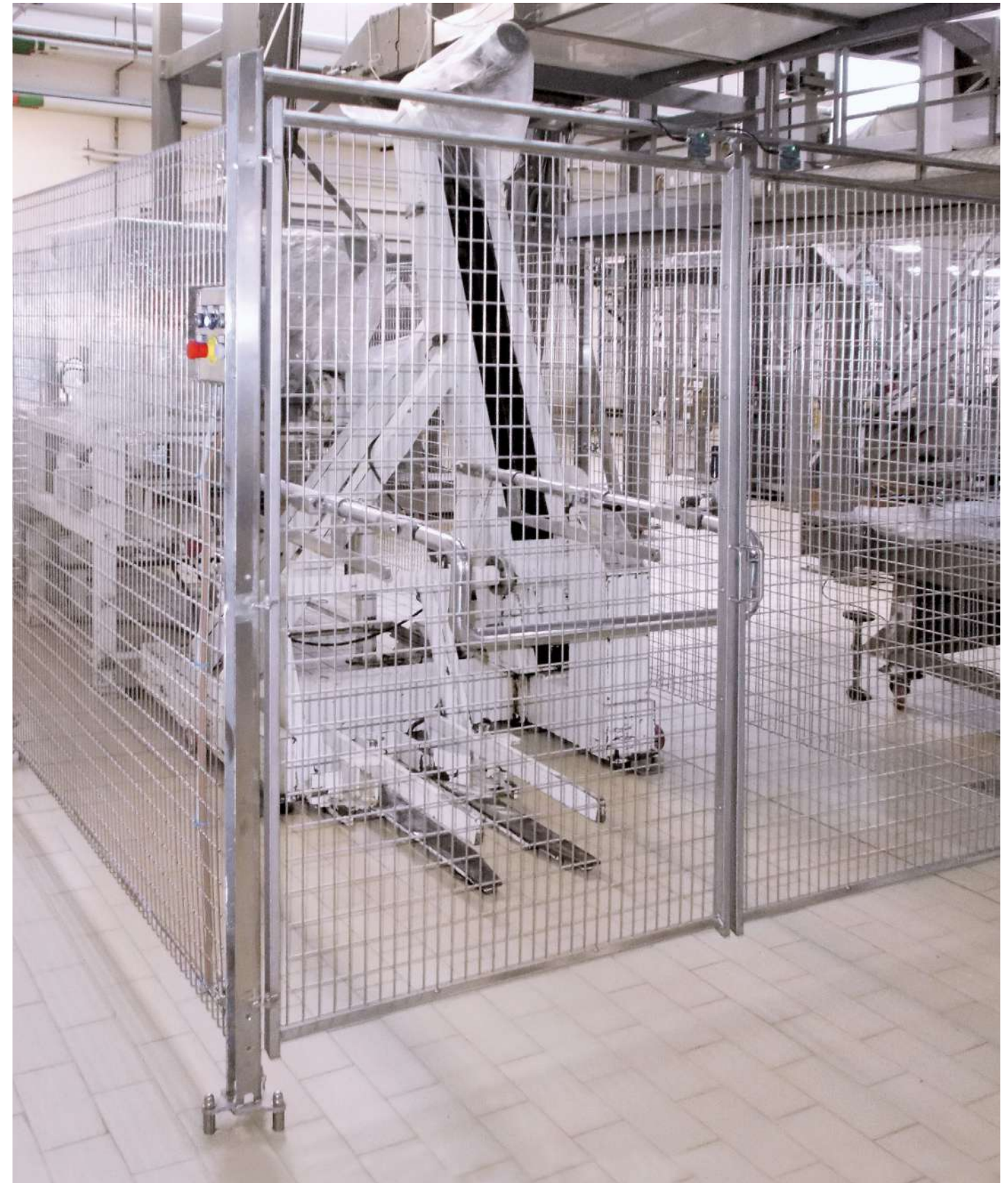
Abgrenzung gefährlicher Maschinenbereiche in der Lebensmittelindustrie.
