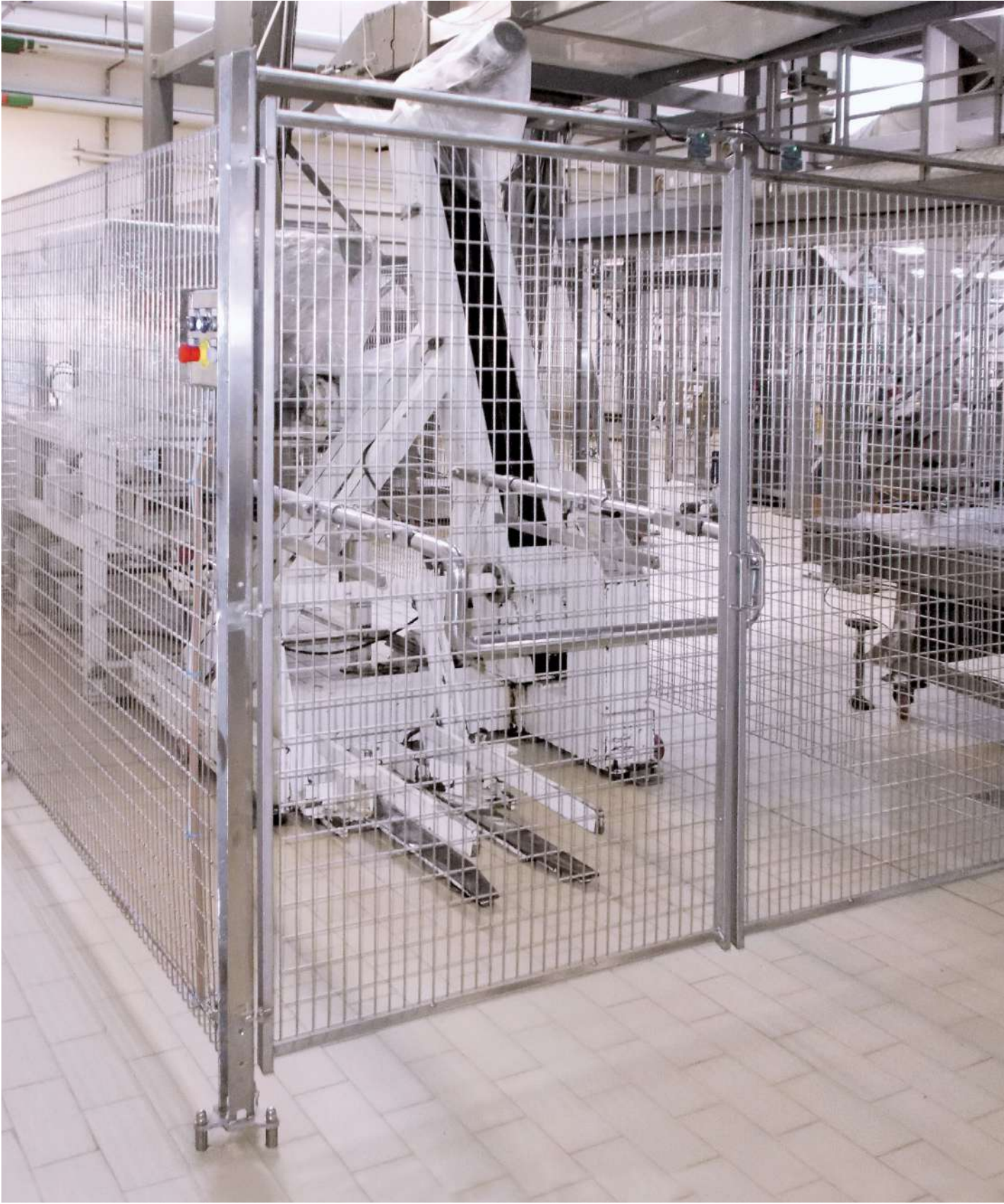
Voorbeeld van toepassingen van het Food Inox systeem voor de afbakening van zones met gevaarlijke machines in de voedingsindustrie.
