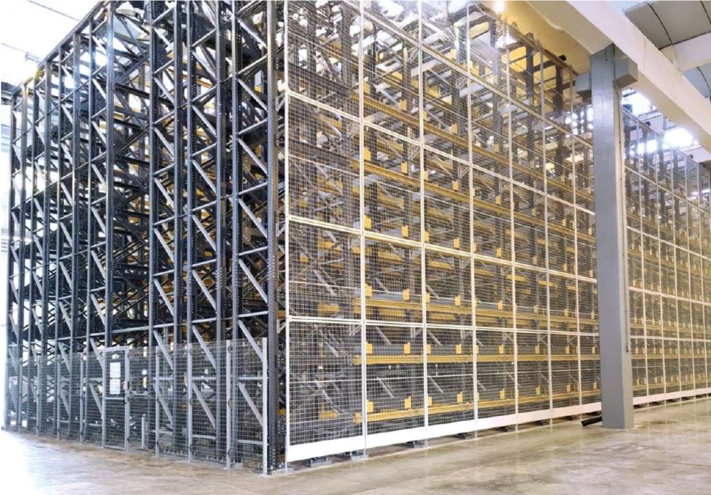
Exemple d'application du système Screen d'un entrepôt automatique d'un entrepôt automatique développé par Automha SpA.
