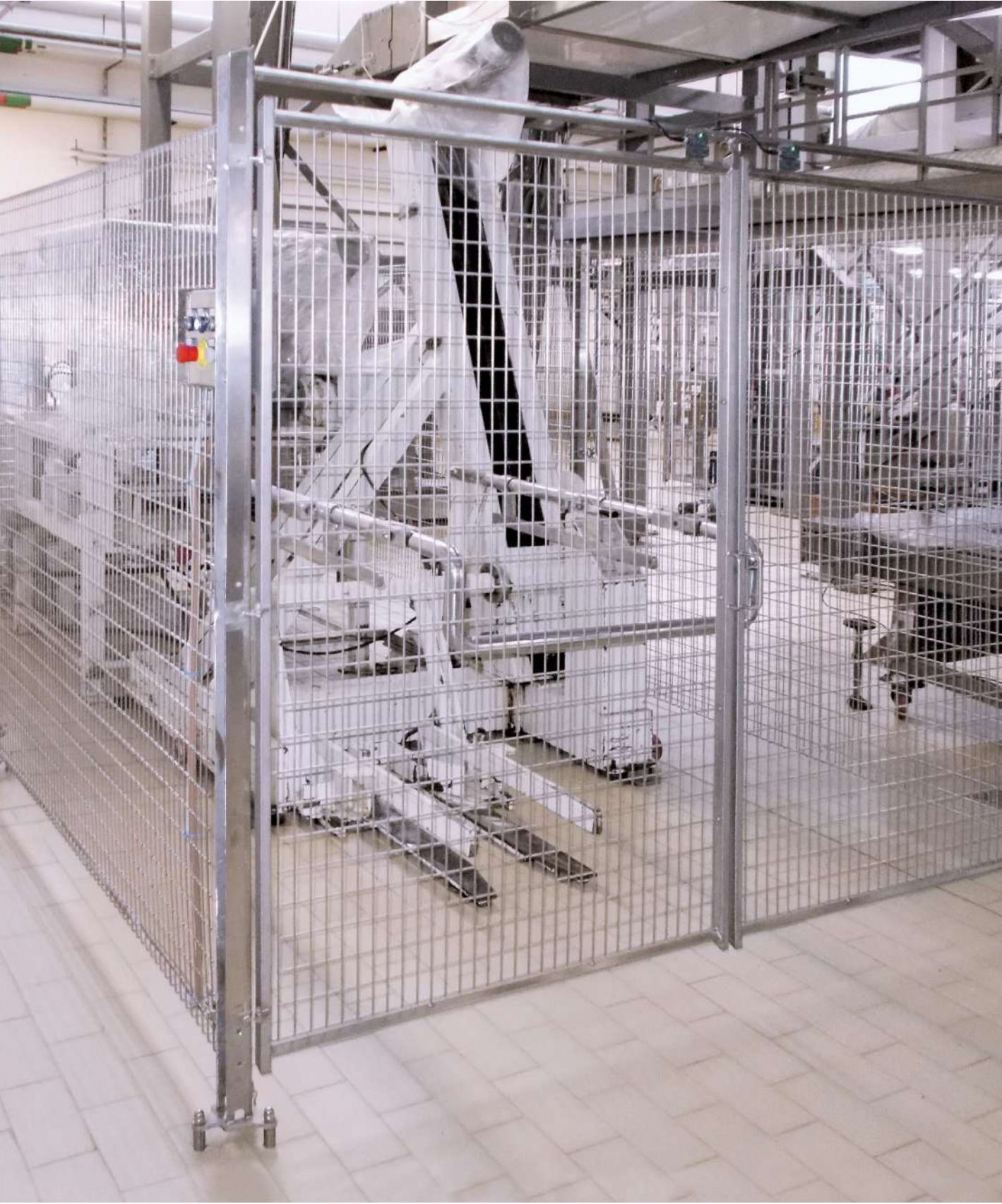
Exemple d'applications du système Food Inox pour la délimitation de zones avec des machines dangereuses dans l'environnement alimentaire.
